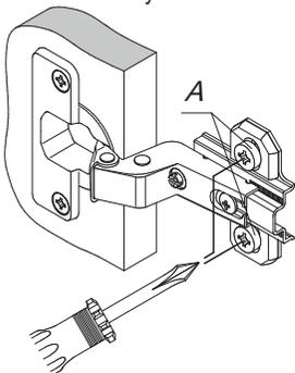
б) Регулирование глубины регулировочный винт "Б" повернуть по или против часовой стрелки, регулируя расстояние между дверью и стенкой боковой.
