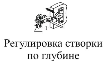
Регулировка створки по глубине
